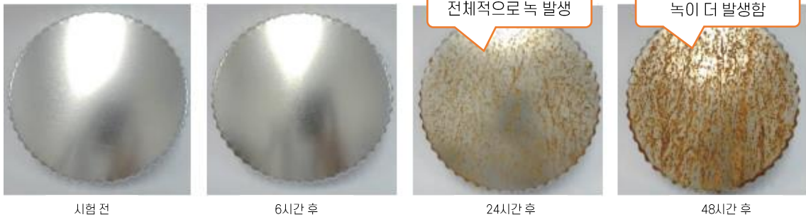
금속제 조리기구(재질 : 철, 주석 도금)으로 염수분무 시험 결과
